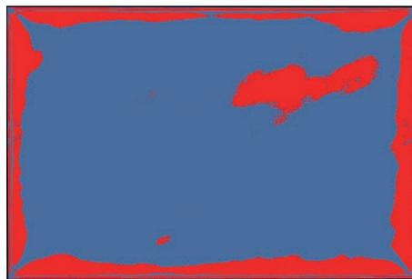
Die Anisotropie-Simulation visualisiert auf Grundlage des gemessenen vektoriiellen Spannungsbildes einer Glasscheibe (links) unerwünschte Anisotropie-Effekte unter ungünstigsten Beleuchtungsbedingungen (rechts).
