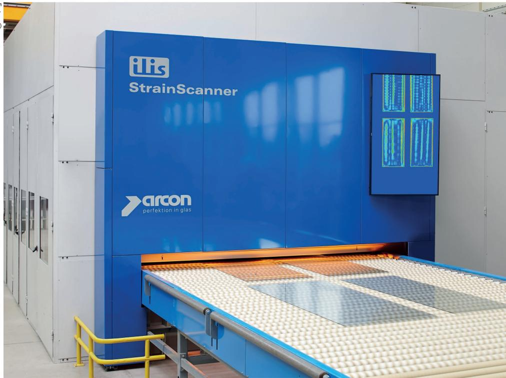
In Kooperation mit arcon entstand in Feuchtwangen der erste Inline-StrainScanner zur objektiven und kontinuierlichen Messung der Vorspannqualität von Einscheibensicherheitsglas.
